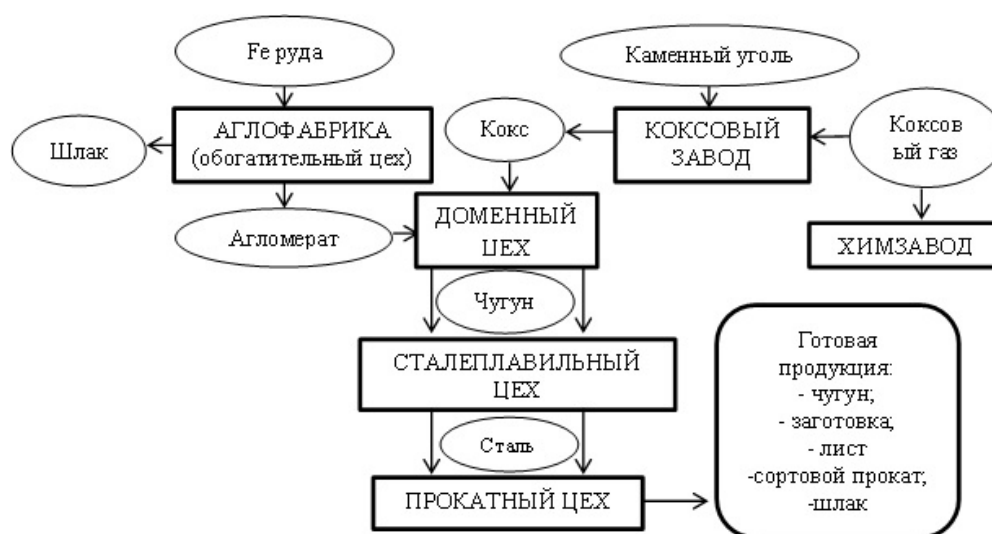
Рисунок 3 Основной процесс металлургического производства
